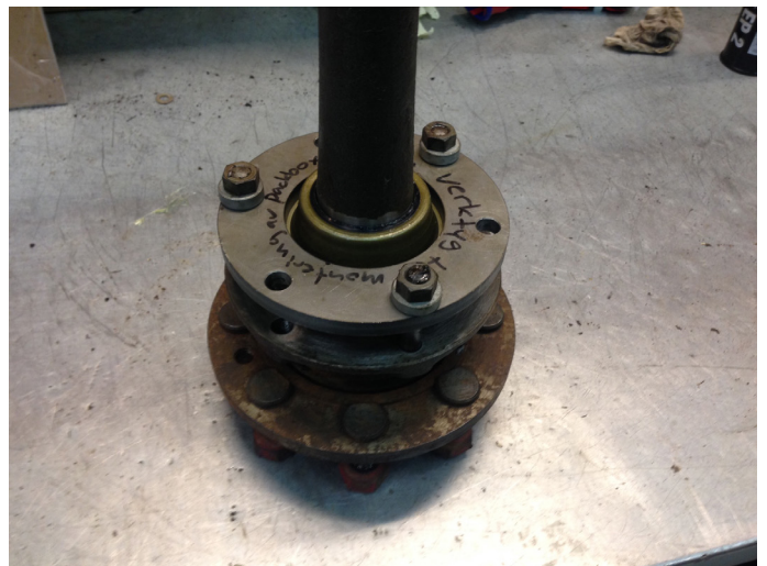
4. Exempel på verktyg som underlättar monteringen och detta verktyg tillverkas av montören. Tätningen dras på plats med muttrarna.
