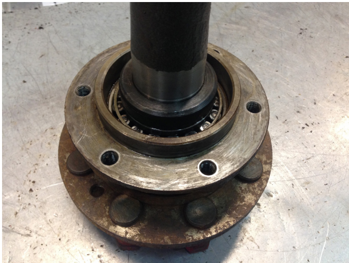
1. Så ser det ut innan tätningen monteras.
