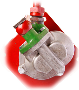
Ursprungligt utförande av hydraulpumpens montering, sedd framifrån.
