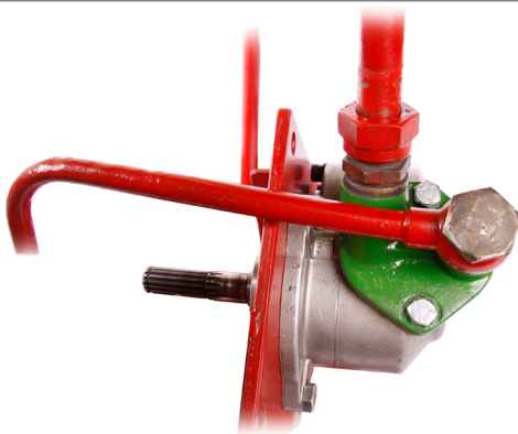
Ursprungligt utförande av hydraulpumpens montering, sedd från höger sida.
